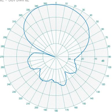
**AZIMUTH PLANE - 5875MHZ**
